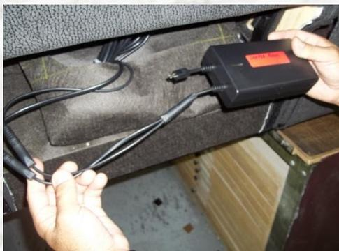
5-Introduisez la batterie dans la pochette et refermez l'extérieur de dos. Rechargez la batterie avec le dispositif (C).
