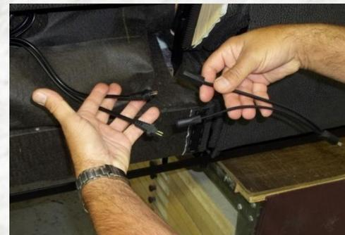
4-Raccordez la batterie (A) avec la fiche du câble à double sortie (B).
